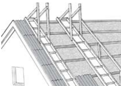
15 pav. Pavyzdys, kaip turi būti kabinamos vaikščiojimui po stogą skirtos kopėčios, montuojant banguotus lakštus.
