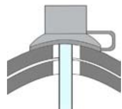
28 pav. Priveržta ir teisingai apsaugine kepuraitė apsaugota montavimo sistema.
