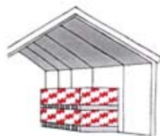
Gaminius reikia laikyti dengtose patalpose. Leidžiama į rietuvę sukrauti dvi paletes vieną ant kitos.
