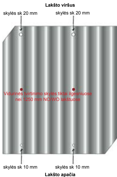
20 pav. Lakštas EUROFALA NO/WO – nupjautų kampų ir tvirtinimo skylių išsidėstymas.
